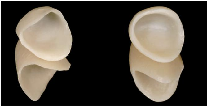
Abb. 20 Zwei Kronenkäppchen aus Zirkoniumdioxid. Links 0,3 mm Wandstärke, rechts 0,7 mm.
