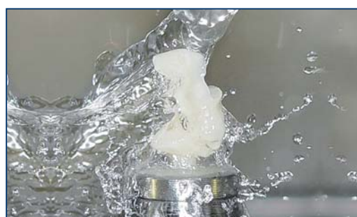
◀ (Abb. 7) Schleifvorgang im 5-Achs-Fräsaautomaten.
