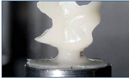
(Abb. 8) ▶ Ein Empress-Inlay (anderer Fall) unmittelbar nach dem Schleifvorgang.
