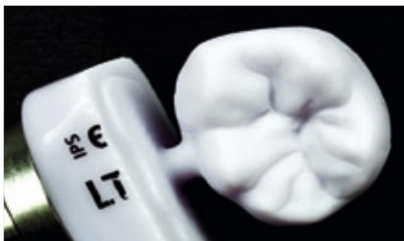
Abb. 3: „As machined“: Aus dem blauen Rohling geschliffene monolithische Krone in der aktuellen Frässtrategie von absolute Ceramics. Kontinuierliche technische Verbesserungen bei der schleifenden Bearbeitung von Dentalkeramik ermöglichen immer idealere Schleifergebnisse.
