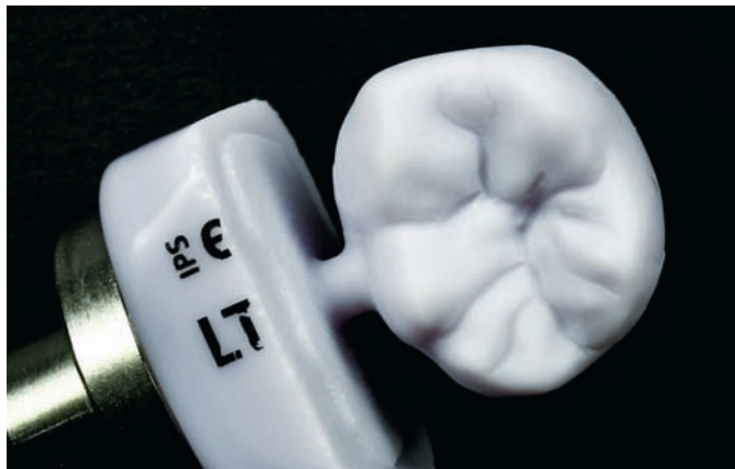
Abbildung 1: Krone aus IPS e.max CAD in aktueller Schleifstrategie von absolute Ceramics: Es resultieren eine seidenmattierte Oberfl6che und ein detailliertes Fissurenrelief.
