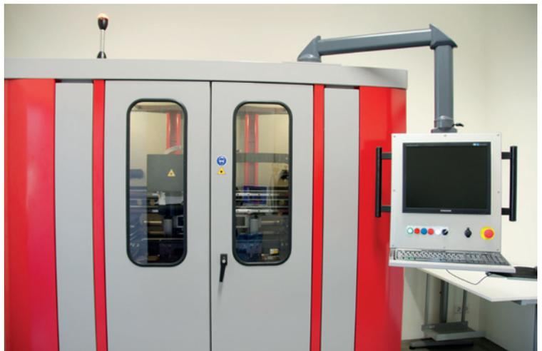
Abb. 2: Die Stereolithografiemaschine D30 von bidentis (D-Leipzig) des Herstellers Dreve (D-Unna) mit Scan-LED-Technologie (SLT).
