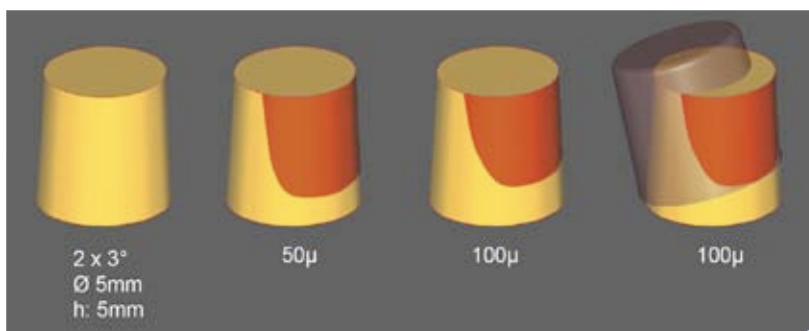
Abb. 10-12: Ausdehnung der „Area of Resistance“ (roter Bereich) 17 . Die Größenordnung des Zementspalteeinflusses ist auf den Abbildungen ebenfalls zu ersehen.
