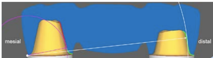
Abb. 13: Nicht zementierte Brücke: Diese sollte auf dem Gipsmodell (ohne mesialen Nachbarzahn) immer dahingehend kontrolliert werden, ob sie sich nach mesial herunterrotieren lässt. Aufgrund der Verblockung liegt der Drehpunkt an der mesialsten Stelle des mesialen Pfeilerzahnes. Selbst wenn dieser Zahnstumpf in sich retentiv ist, so besteht je nach Größe der Zementfuge und Stumpfgeometrie immer eine initiale Beweglichkeit (grün, mesial), bis eine okklusale Kollision der Kroneninnenfläche an der distalen Wand des Stumpfes die Bewegung hemmt. Sofern am distalen Pfeilerzahn wegen des vergrößerten Radius (weiß) keinerlei mechanischer Widerstand auftritt (grün, distal), hängt die sichere Verankerung der Brücke allein am mesialen Pfeiler.
