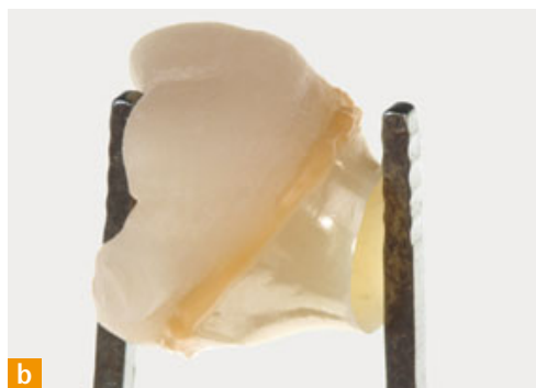
Abb. 9a und b Klemmhalterung der beiden Sinterverbundkomponenten während der Ofensinterung.
