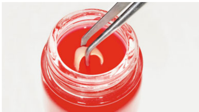
Abb. 14 und 15 Überprüfung der kompletten Versiegelung der Sinterfuge mittels Farbpenetrationstest.
